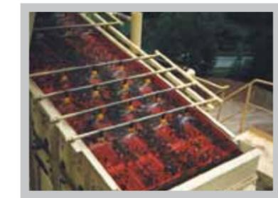
**Siebe** ■ Aus Kunststoff, Gummi, als Drahtsiebe oder als Lochblech ■ Spannsiebe, Plansiebe oder Stecksysteme
