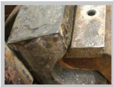
Brecher & Prallmühlen ■ Für viele Fabrikate Schlagleisten und Brechbacken ■ Aus hochlegiertem Chromhartguss ■ Aus Mangan-Hartstahlguss ■ Brecherauskleidungen aus Hartguss oder hochverschleißfestem Blech
