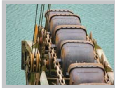
Eimerkettenbagger ■ Baggereimer neu und regeneriert ■ Schaken, Böcke, Bolzen, Buchsen und Ketten
