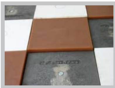
Mosaik-Mix ■ Verschleißfeste Kacheln aus Gummi, Hartguss, Keramik und Polyurethan ■ Schraubbar und beliebig kombinierbar in verschiedenen Formaten ■ Für Rutschen und Rinnen
